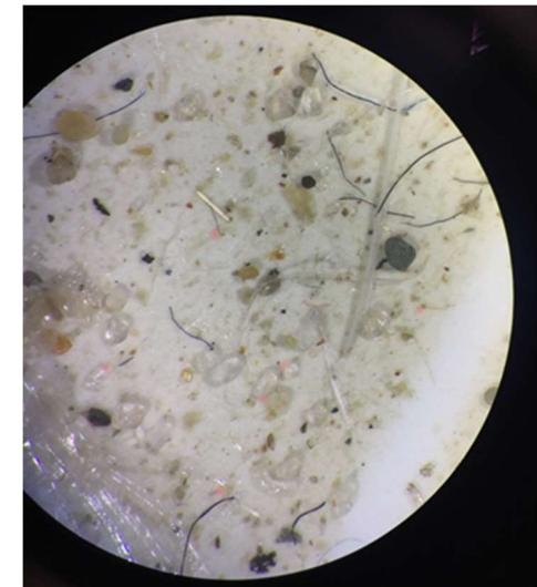
*Photo 3: Filtre avec microplastiques (principalement des fibres) – Vercauteren et al. (2021)<sup>xlvi</sup>*
