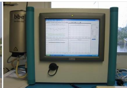
*Figuur 3 : toestel voor continue meting van chlorofyl a en algengroepen dat in de automatische meetpunten staat (Agence de l'Eau Artois-Picardie) meet om de 10 minuten over lange perioden (figuur 3 meetpunt en AOL<sup>xx</sup>).*
